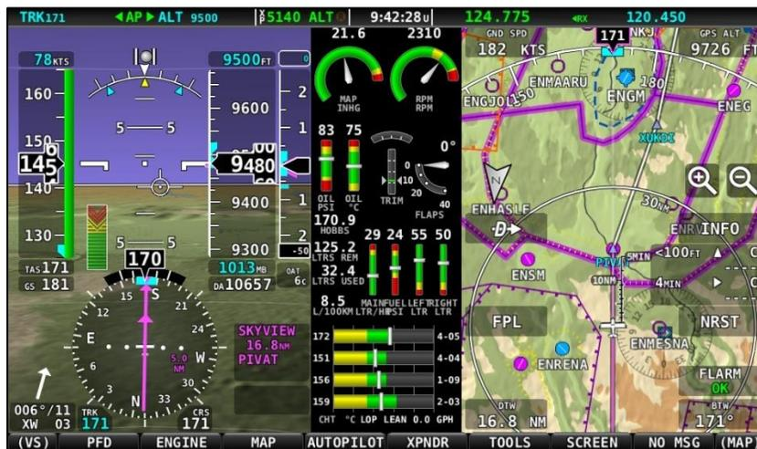
Exemple de l'instrumentation du RV7 : à gauche l'horizon artificiel avec une image de synthèse du relief, au centre les paramètres moteur et à droite la carte.
